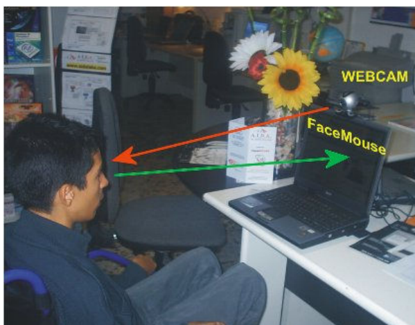
La webcam inquadra l'utente che muovendo una parte del corpo, come ad esempio il capo, utilizza FaceMOUSE spostando il cursore del mouse sullo schermo.
